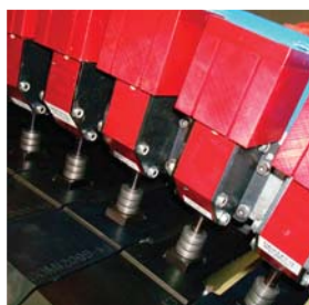
Model 8031 Standardno pnevmatsko vpenjalo v napravi za varjenje s trenjem
