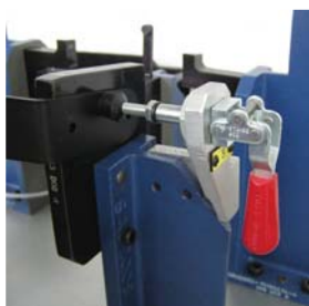
Model 602 potisno vpenjalo v napravi za kontroliranje v avtomobilski industriji
