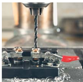
Model 205-U Vodoravno vpenjalo v vrtalni napravi
